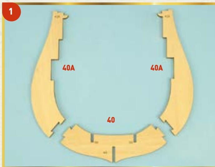
1 Сегодня мы добавим к каркасу корпуса два новых шпангоута и завершим работу над веслами, которая была начата в прошлом выпуске. Возьмите детали (40) и (40A) и склейте их небольшим количеством клея, собрав таким образом одиннадцатый шпангоут модели. Используйте ту же технику, которую вы применяли для сборки предыдущих шпангоутов, и не забывайте класть детали на ровную поверхность.
